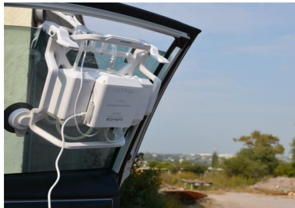
Imagen 3. Sniffer montado en vehículo
