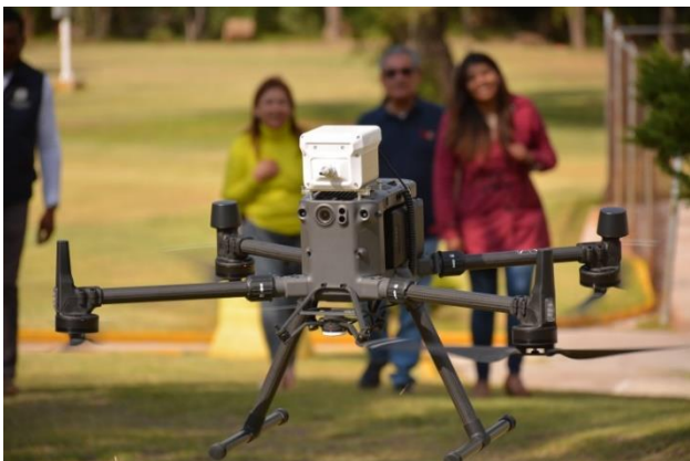
Imagen 4. Sniffer montado en drone Matrice 300
